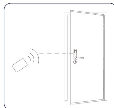
La configuración de los lectores se hace a través de una conexión Micro USB o creando una tarjeta de configuración.
