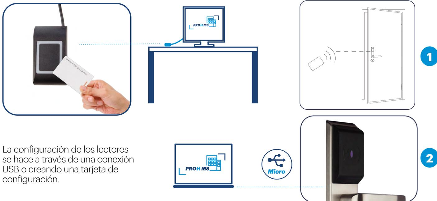
La configuración de los lectores se hace a través de una conexión USB o creando una tarjeta de configuración.
