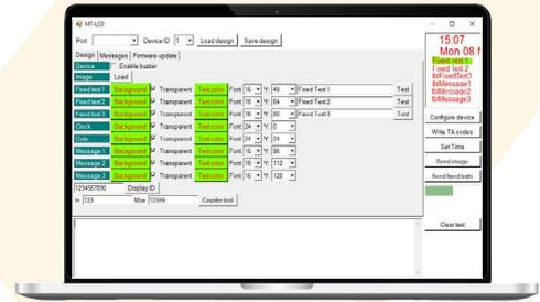
**XPR Toolbox** es un nuevo software fácil de usar diseñado para lectores XPR con bus RS-485 o puerto micro-USB.
