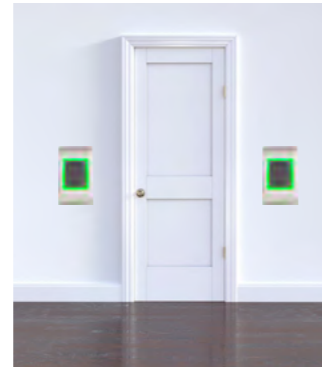
Kombination 2 1 Tür mit 2 Lesegeräten (In und Out - Anti Pass Back)
